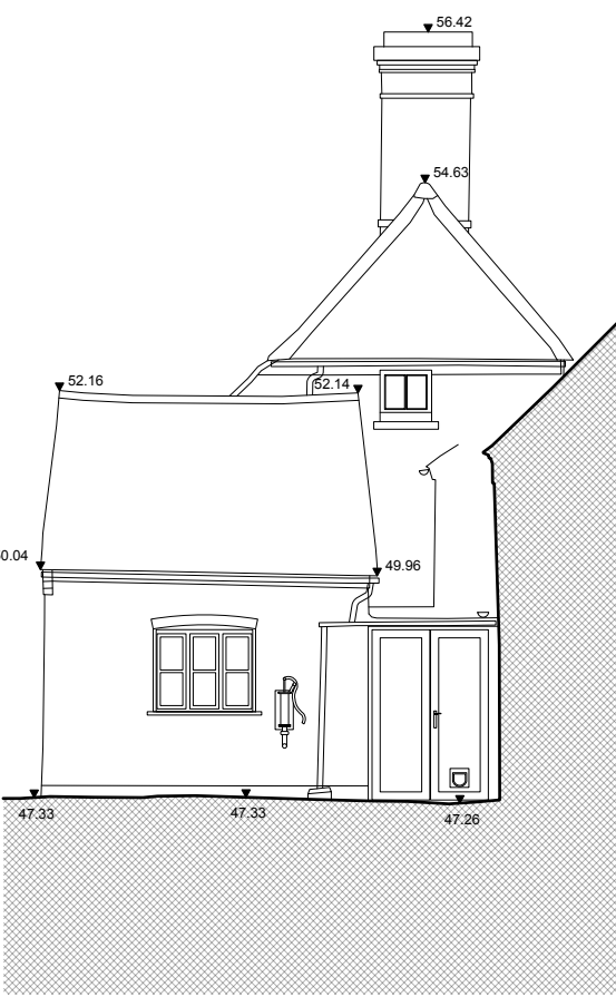
ELV 13A Existing Elevation 1:100
